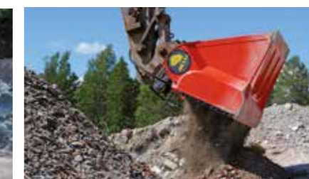
Verkleinen van zachte gevelsteen/ losmaken van gefreesd asfalt
